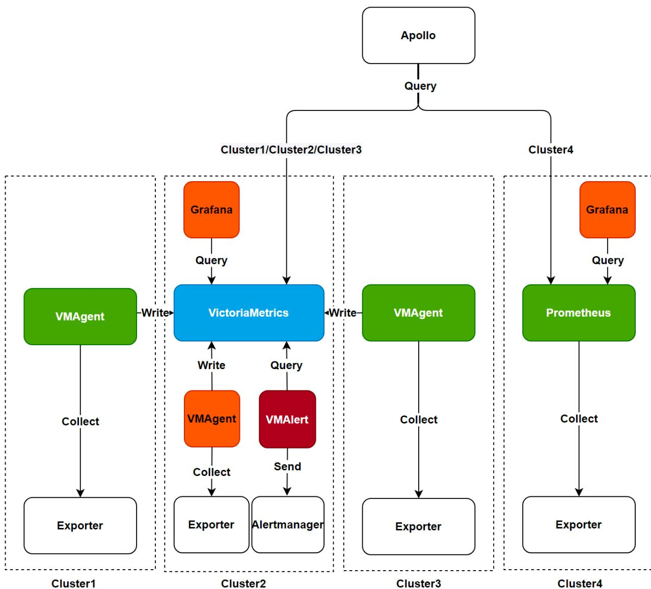
上图展示了平台支持的监控组件安装架构及数据流向。平台提供以下两种安装方式供选择：
