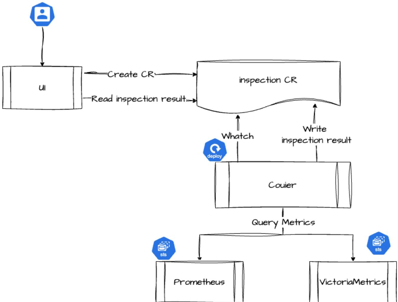
Inspection 模块由平台组件 Courier 和监控组件共同提供，涉及以下业务流程：
