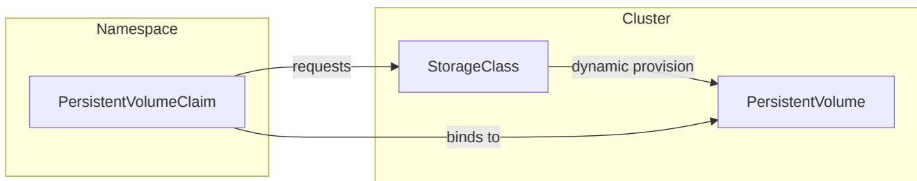
图示：PVC、PV 与 StorageClass 之间的关系。
