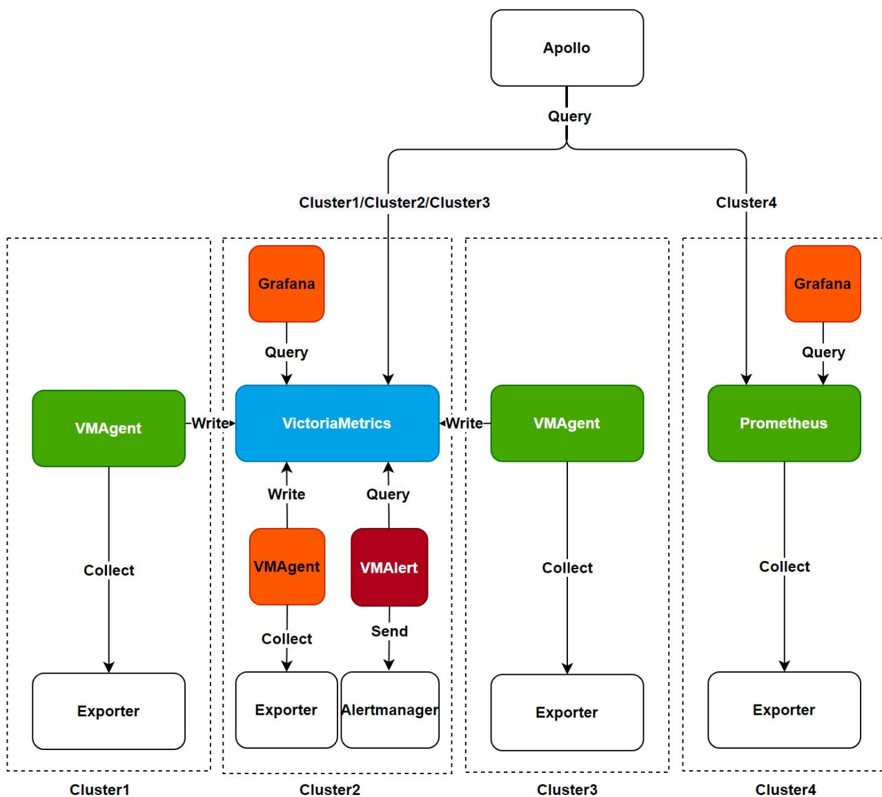
上图展示了平台支持的监控组件安装架构和数据流向。平台提供以下两种安装方式供选择：
